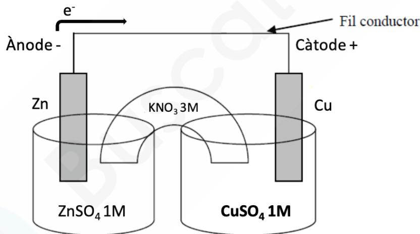
Es considera correcte (però no es necessari fer-ho) si es col·loca un voltímetre (potenciòmetre) en el fil conductor que uneix l'elèctrode de Zn i l'elèctrode de Cu.
